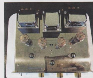
Vista delle valvole, una ECC82, due ECC83 e quattro 6L6 di potenza.
