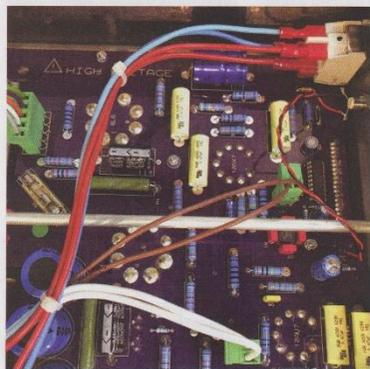
Dettaglio della sezione di filtraggio dell'alimentazione.
